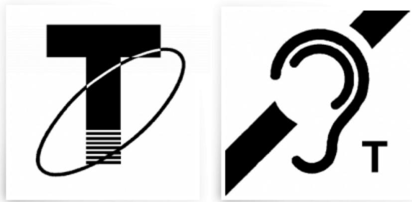
Induktiosilmukan symbolit, jälkimmäinen on kansainvälisen IEC-standardin mukainen symboli. 6
