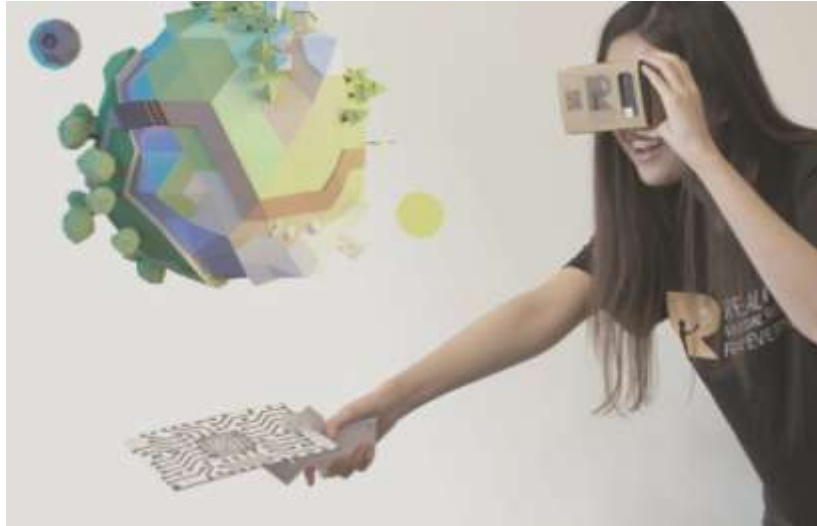
Kuva 32. Realiteer-yhtiön RealControl-ohjain on QR-koodialusta, jonka sijainnin ja suunnan sovellus rekisteröi älypuhelimien kameraa käyttäen.
