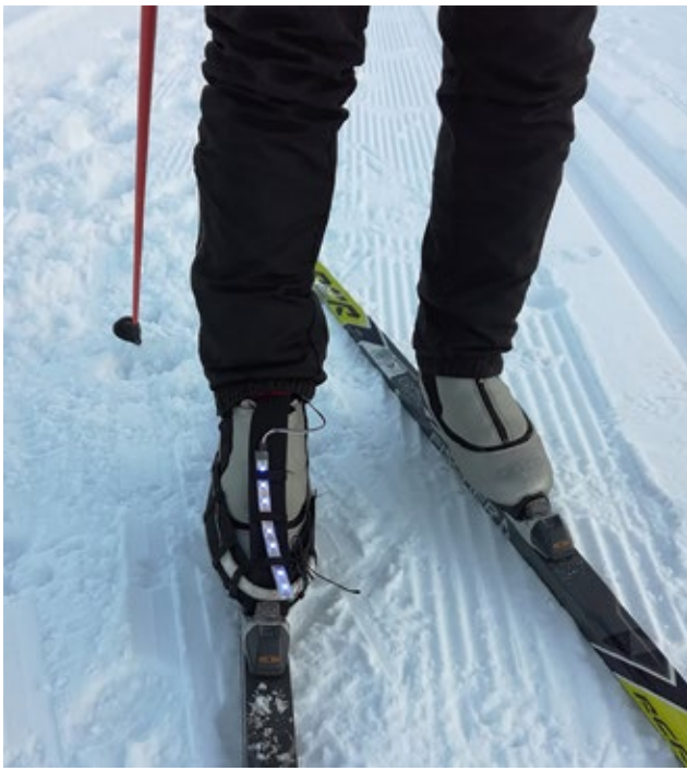
Kuva 3. Vasemmalla: Hiihtomonoon kiinnitettyt valot kertovat värillään hiihtäjän nopeuden. Oikealla: Tavoitenopeus asetetaan mobiilisovelluksella. Kuvat: Jonna Häkkinä, 2018.
