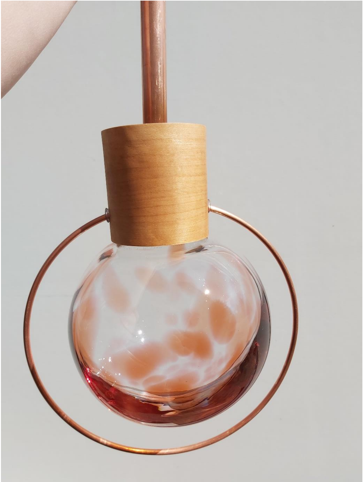
Kuva 38. Valmis kapasitiivisella sensorilla toimivan interaktiivisen valaisimen prototyyppi.
