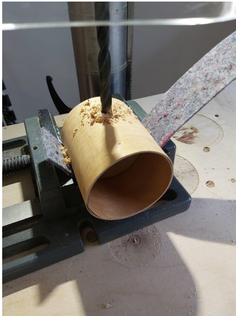
Kuva 22. Reikien poraaminen puuosaan.
