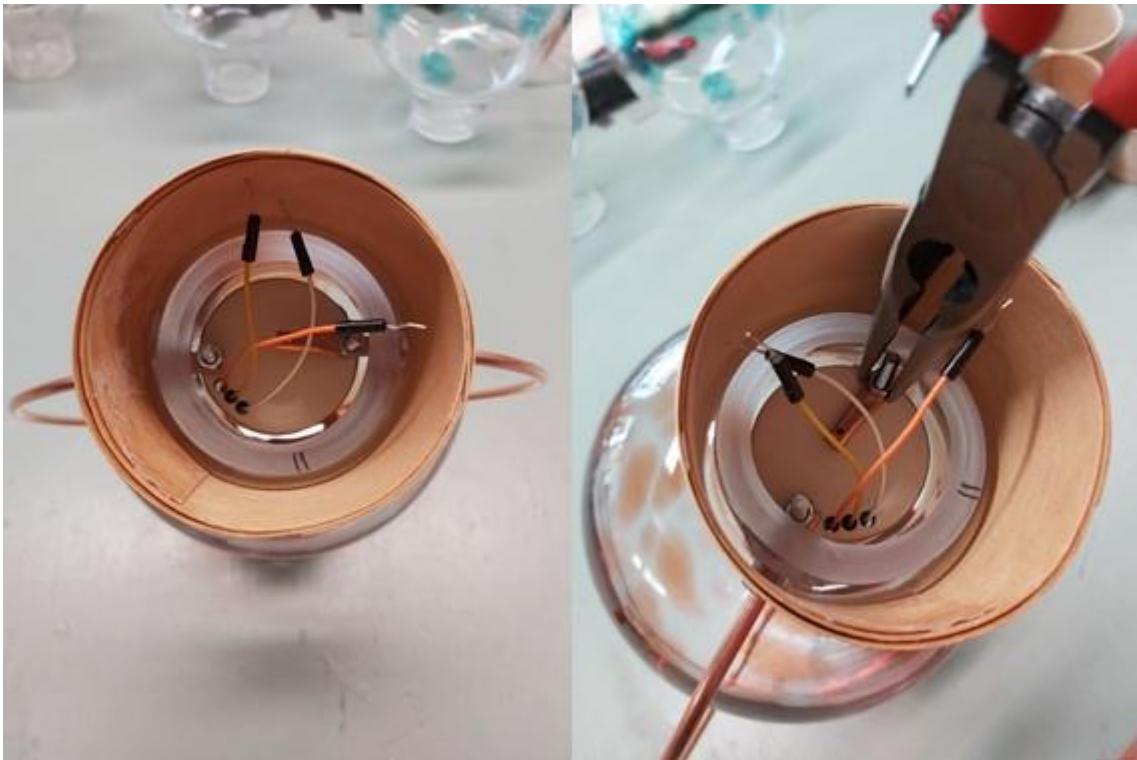
Kuva 28. Teknisten osien sovittaminen lasiosan sisään.
