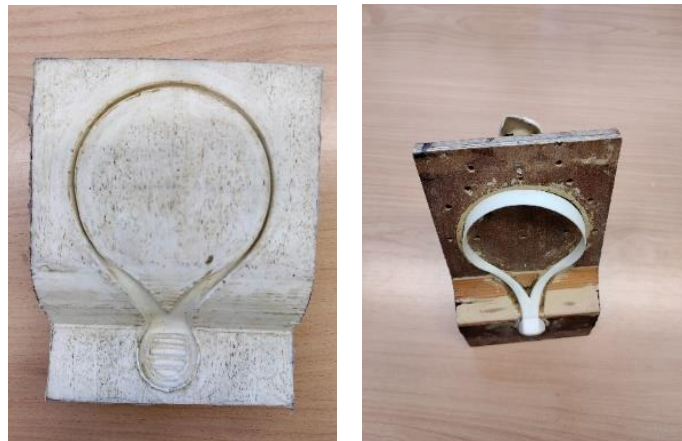
Kuvat 6 ja 7. Leskisen tekemiä muotteja Exel-suksisauvoista ja -sommista. Desinarkiston muottimateriaaliaineistoa.
