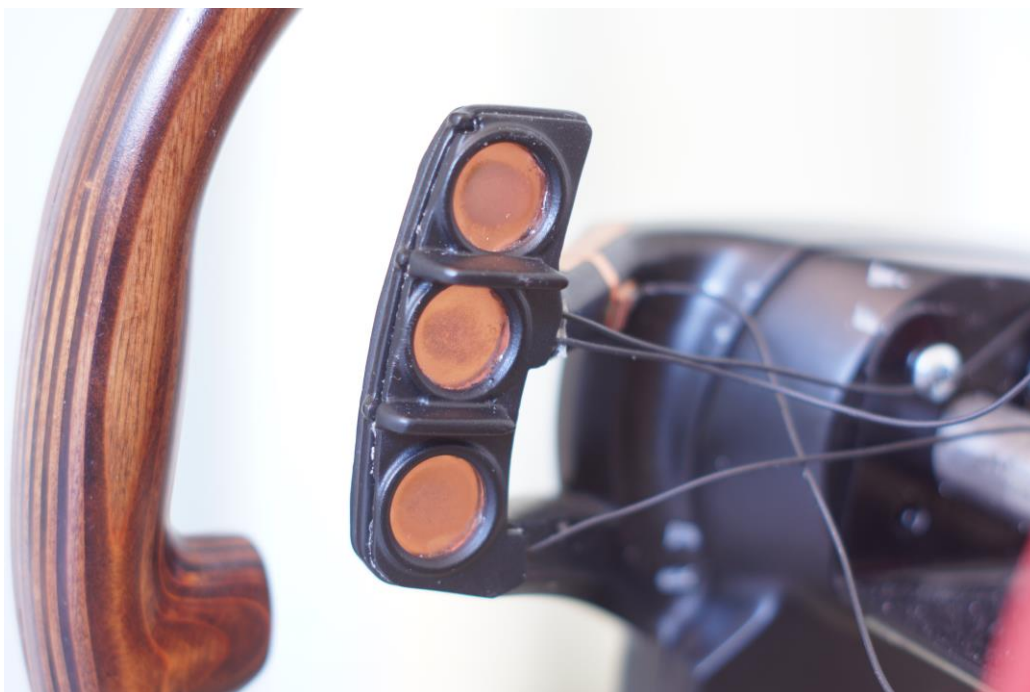
Kuva 12. Parannetut kontaktipinnat ja lisätyt käyttäjää ohjaavat muodot.
