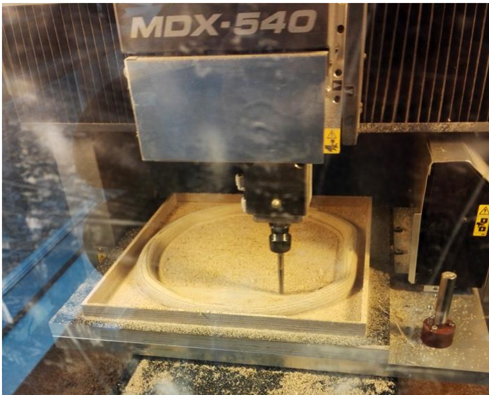
Kuva 8. Ohjauspyörän kehä työstyy CNC-jyrsimessä.
