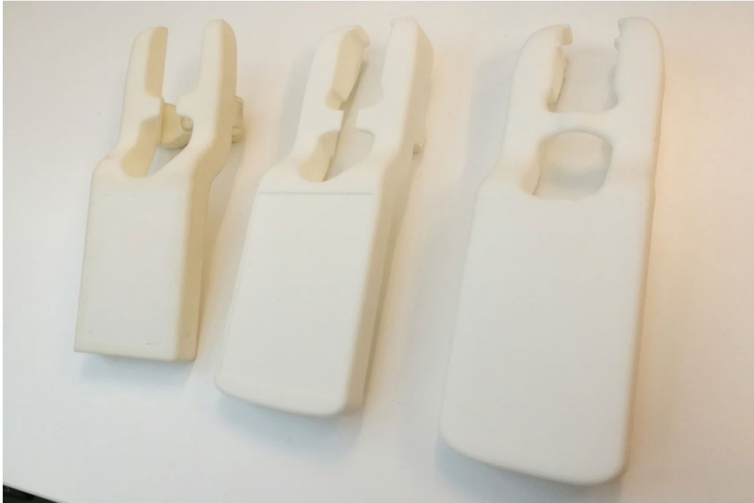
Muodon kehittyminen kuvassa. Oikeassa reunassa viimeinen designmuutos, jossa laitteen etupuolen tuet yhdistettiin siltamaiseksi muodoksi
