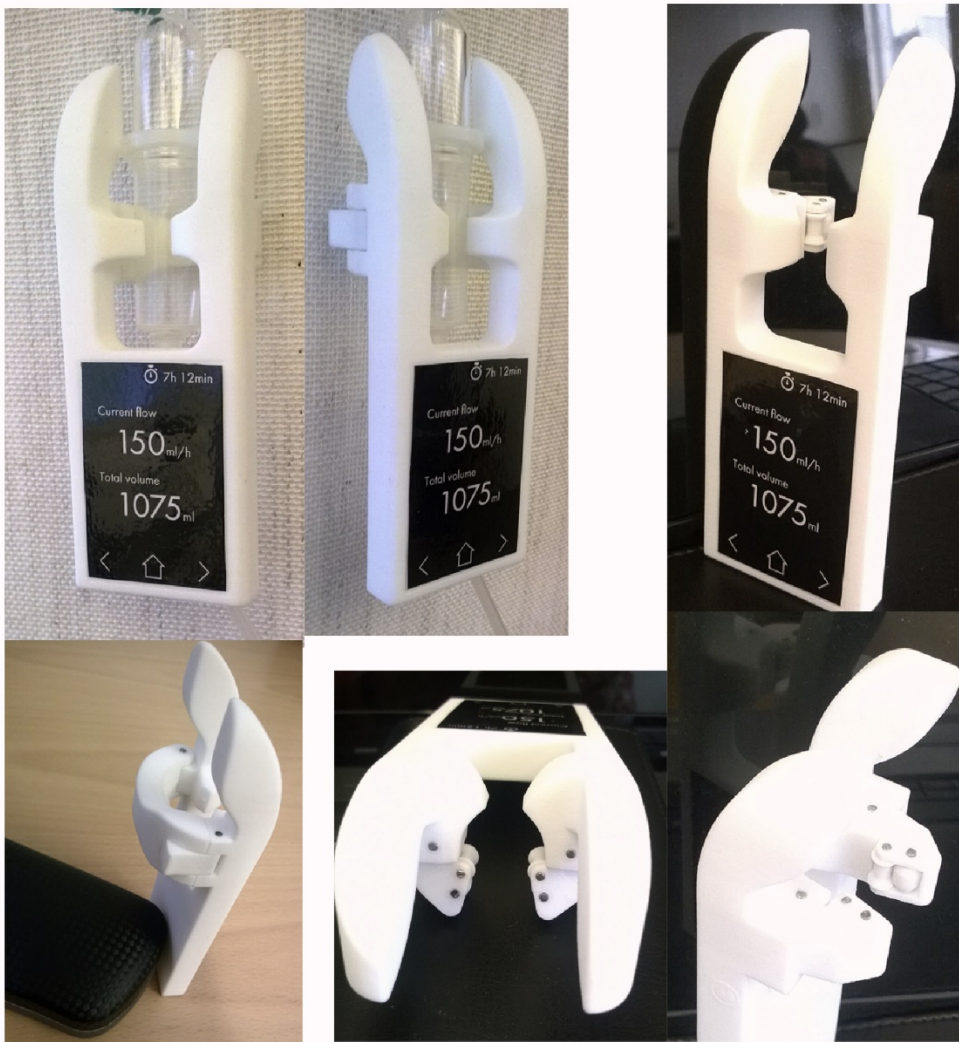
Alkuvaiheen 3D-tulosteita, joilla testattiin kiinnitysmekanismia
