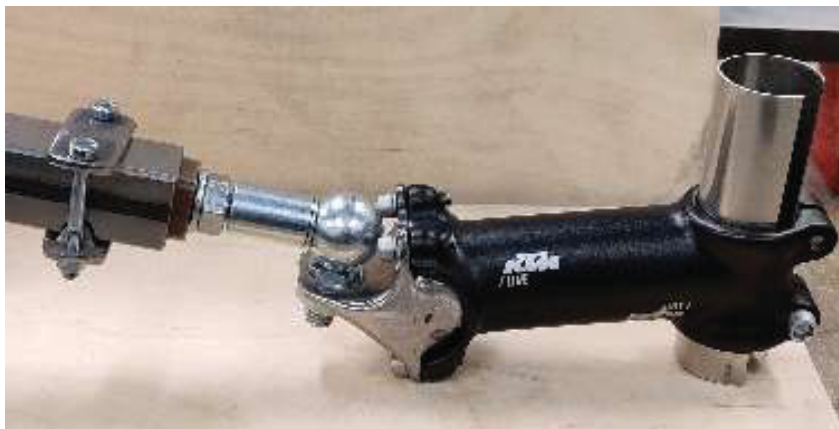
KUVA 14. VETOAISAN JA POLKUPYÖRÄN LIITOSKOHTA VALMIINA. MUSTA STEMMIOSA OIKEALLA ON VALMISTUOTANTOA, JOHON VALMISTIN OMAN LIITOKSEN. OSA KIINNITETÄÄN POLKUPYÖRÄN SATULAPUTKEEN. KUVAAJA TOMMI YLÄJOKI 2022.
