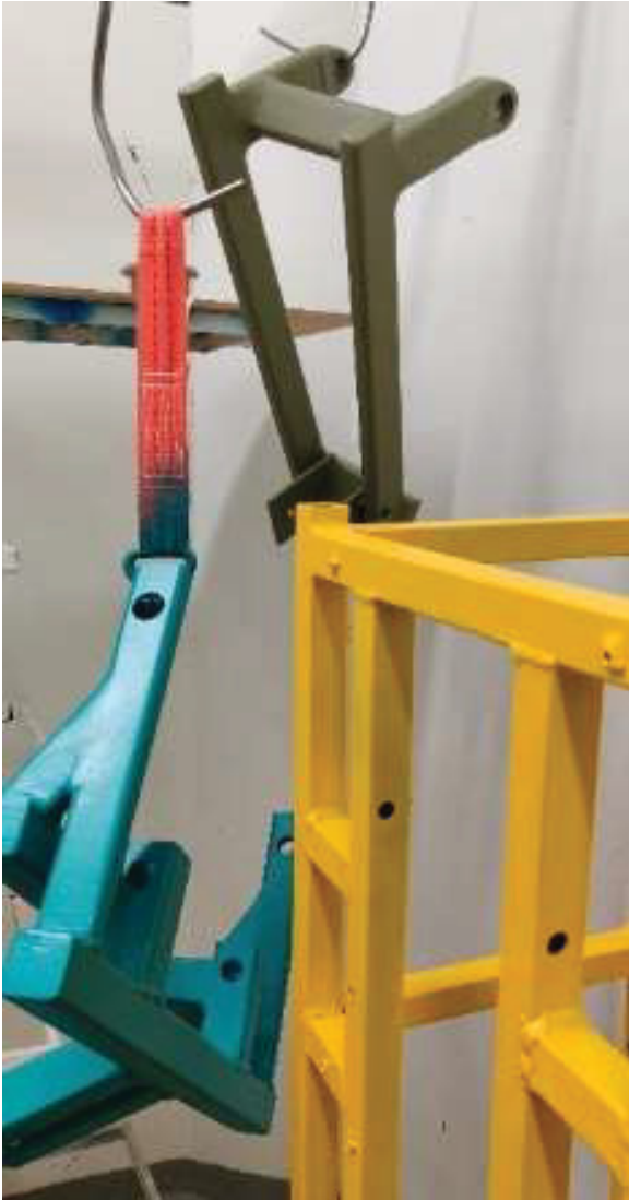
KUVA 15. VALMIIT OSAT MAALAUKSEN JÄLKEEN KUIVUMASSA. KUVAAJA TOMMI YLÄJOKI 2022.
