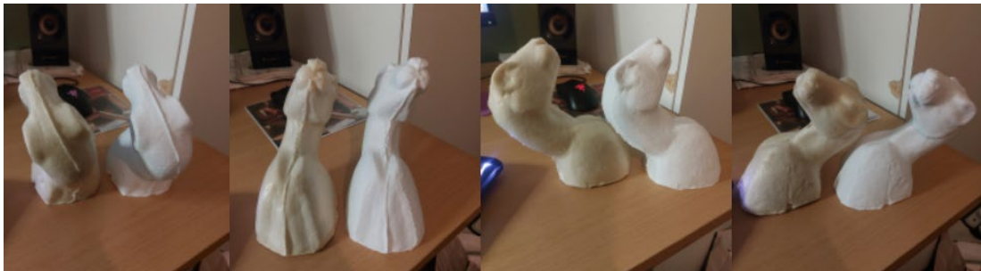
Kuva 16. Vasemmanpuoleinen on jäniksen uretaanikeho, oikealla on siitä raakaskannattu ja 3D-tulostettu malli FDM-printterillä. Kuvat: Topi Juusola, 2025.
