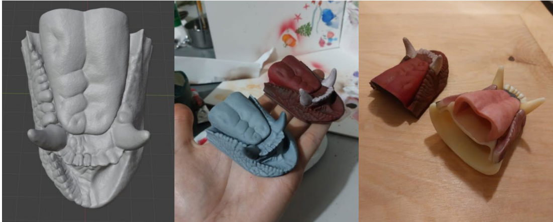
Kuva 19. Mallinnuksen vasen puoli on käsitelty skannattuun pintaan, joten yksityiskohtien määrän saa lisättyä huomattavasti realistisemmaksi. Osa yksityiskohdista jää maalauksessa piiloon, joten niiden korostaminen alkuperäiseen malliin on suotavaa. Kuvat: Topi Juusola, 2026.
