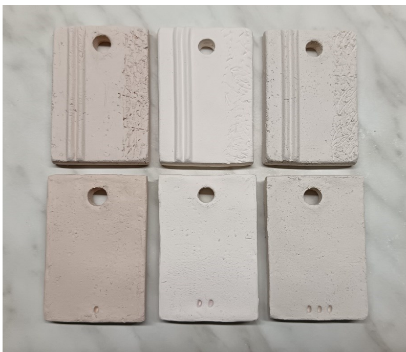
Kuva 7. Valmiit koepalat raakapolton jälkeen. Ylärivillä koepalojen etupuoli ja alarivillä nurja puoli.
