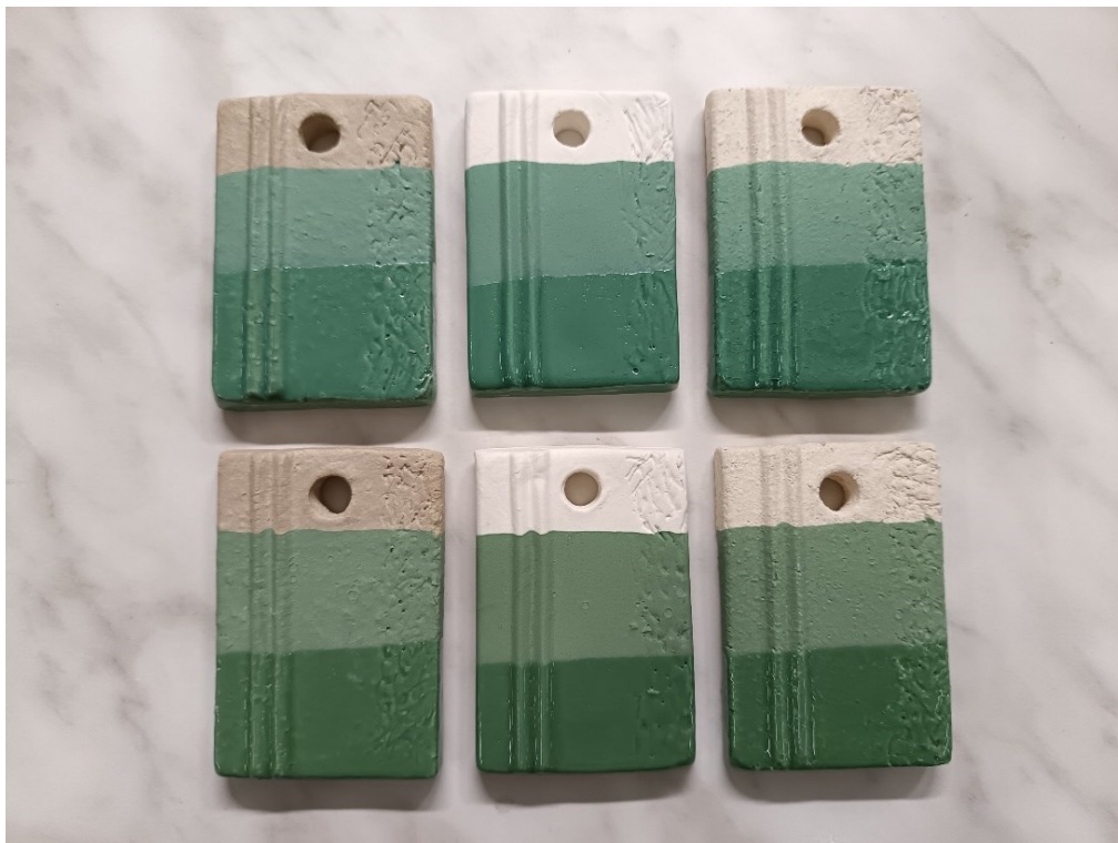
Kuva 11. Pilotin koepalat poltettuina. Kuvassa ylärivillä koepalat sen värin reseptille, josta lähdin liikkeelle. Alarivillä ensimmäinen muuttamani sävy.
