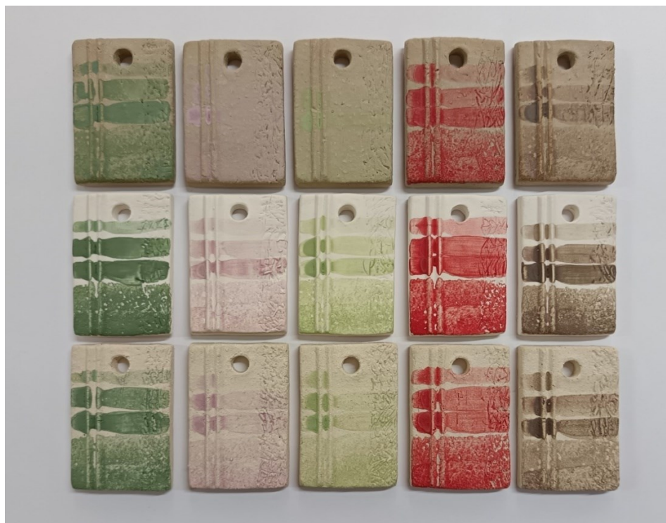
Kuva 19. Kuva koepaloista, joihin enkopeja on levitetty siveltimellä ja telalla.
