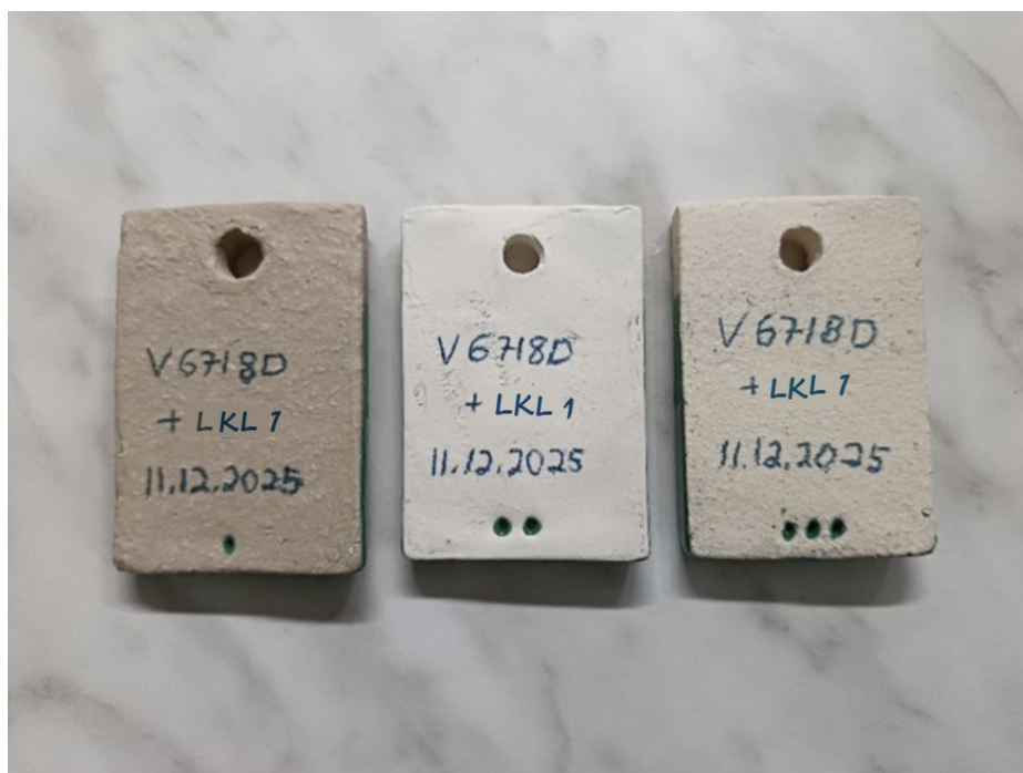
Kuva 13. Koepalojen takana olevia merkkauksia lasituspolton jälkeen.
