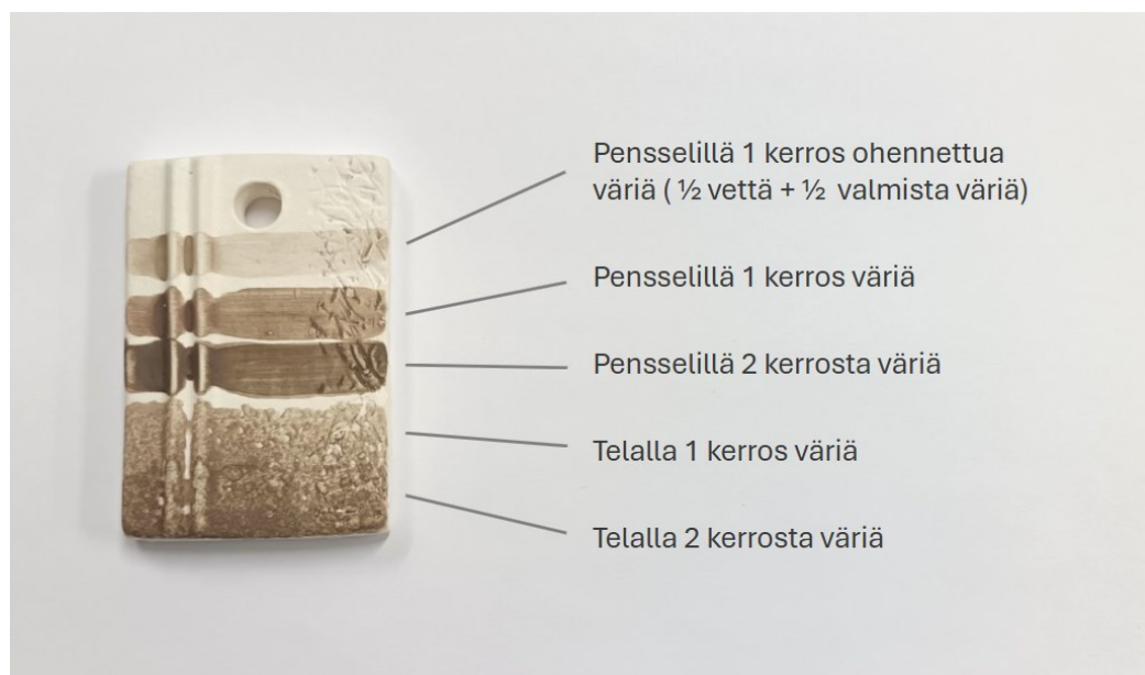
Kuva 18. Selitys värien levitystavasta koepalan pinnalle.
