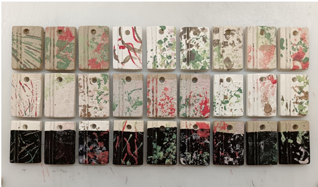
Kuva 24. Koepalat erilaisista enkopien levitysmenetelmistä lasituspolton jälkeen. Palat ovat samassa järjestyksessä kuin kuvassa 23.
