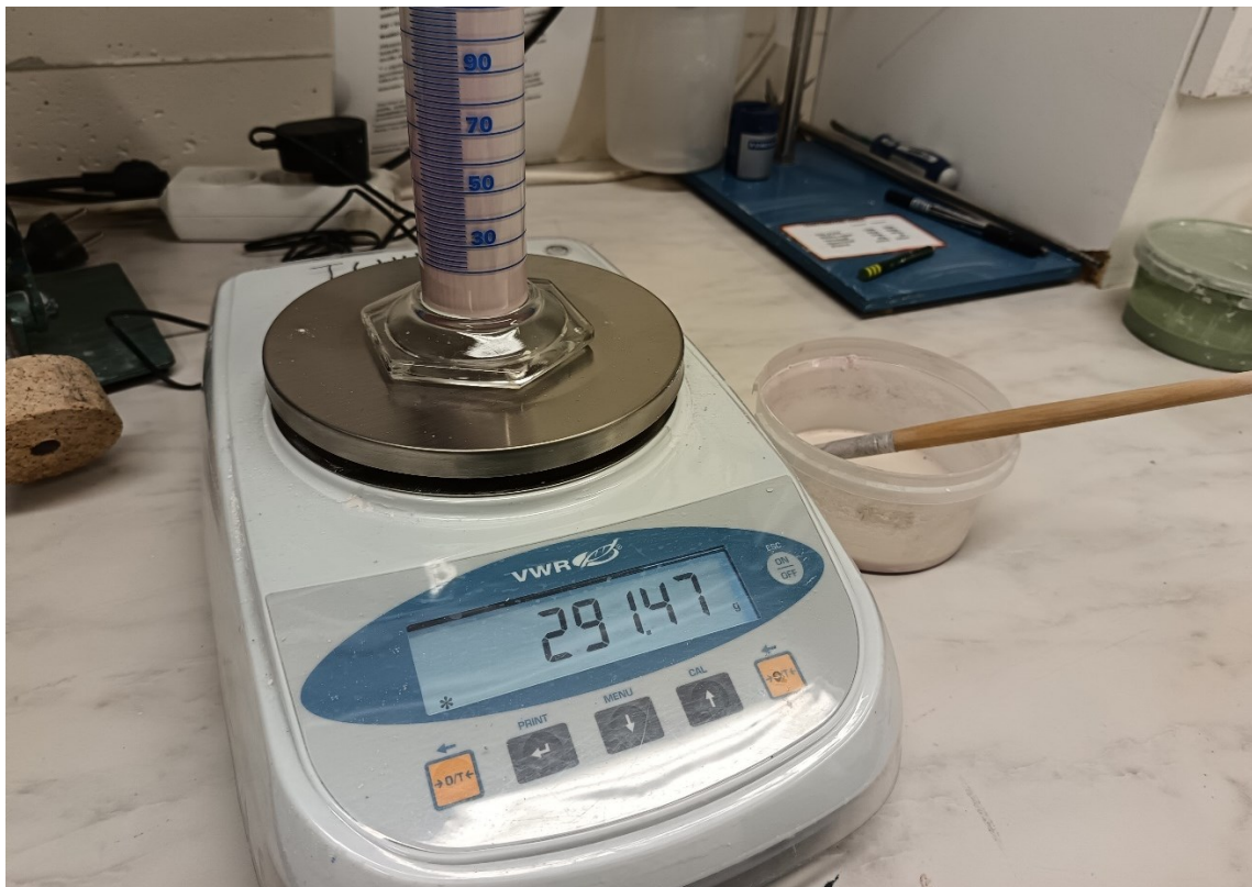
Kuva 17. Enkopin ominaispainon mittaamista mittalasin ja tarkkuusvaa'an avulla.
