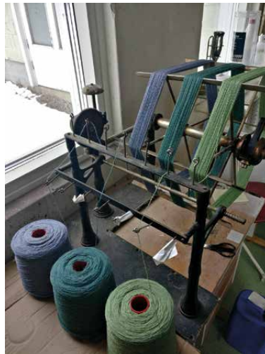
▲ KUVA 6. Kartiolla värjäämisen jälkeen langat voitoin vyyhdätä myyntieriin myös käsin veivattavalla vyyhtäkoneella. Valokuva: Anna Vasko, 2020.
