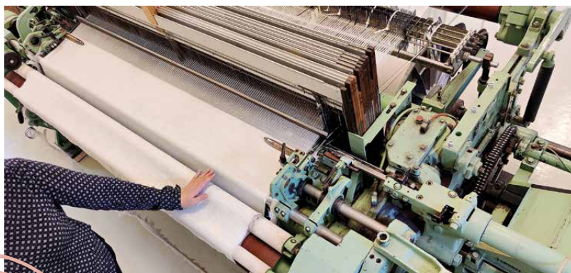
KUVA 4. Kutomakone Dora: Kultavilla Oy:n Dornier-kutomakoneeseen saatiin teetettyä myös vaaleampi loimi kainuunharmaavillasta, jota haettiin ja lajiteltiin itse lammastiloilla. Lanka kehrättiin Virossa Ramellan-kehruukoneilla. Siitä syntyi hienoin lanka, jota olen saanut käsitellä! Valokuva: Susanna Kääriäinen, 2022.
