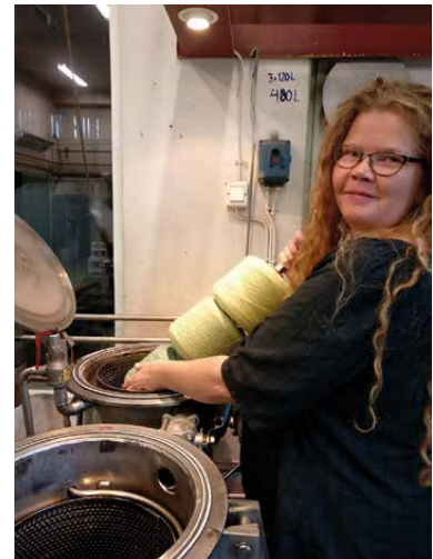
▲ KUVA 7. Anna värjää: Värjäyskoneeseen menee enimmillään kuusi kartiota kolmeen sylinteriin, jossa väriaine kiertää: n. 18 kilon erä. Valokuva: Susanna Kääriäinen, 2020.
