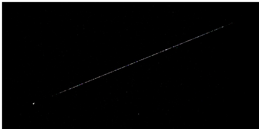
Kuva 4.10. Esimerkki kennoon osuneesta poikkeuksellisen korkeaenergisestä hiukkasesta. Rajattu täyskennonisen kameran kuvasta. Kuva: EPI (2024).
